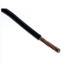
RS PRO Single Core Conduit Cable HO7V-R Conduit & Trunking Cable, 16 mm 2 CSA , 450 V dc, 750 V ac, Black PVC 50m, Кабель
