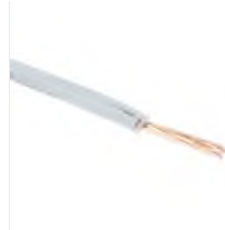
RS PRO 6491B H07Z-R Conduit Cable, 1.5 mm 2 CSA , 750 V, Grey, Кабель
