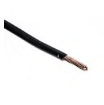
RS PRO Single Core Conduit Cable HO7V-R Conduit & Trunking Cable, 25 mm 2 CSA , 450 V dc, 750 V ac, Black PVC 50m, Кабель
